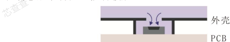
图11：外壳上合适的窗口提供了良好的环境测量通道，空气交换更充分。
